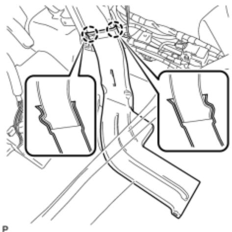
(d) Disengage the 2 claws and remove the rear No. 2 air duct.
