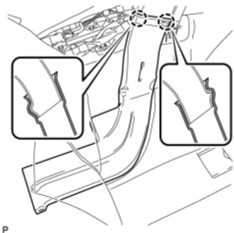
(d) Disengage the 2 claws and remove the rear No. 3 air duct.
